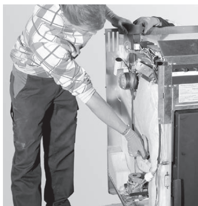
Fig. 12 Posizione della maniglia sul tubo della coclea e sul bocchettone dei gas combustivi
