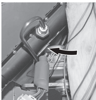
Fig. 44 Introdurre completamente la sonda per il termostato di sicurezza del tubo della coclea
