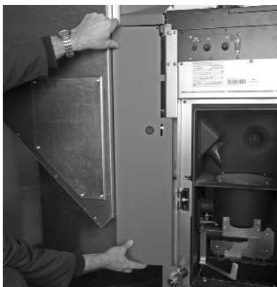
fig. 32 Infilare il rivestimento anteriore
