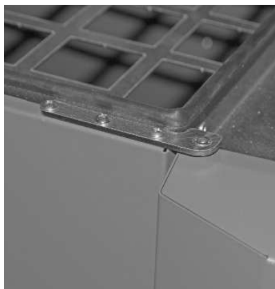
fig. 37 Avvitare la cerniera della porta con la porta di contenimento agganciata
