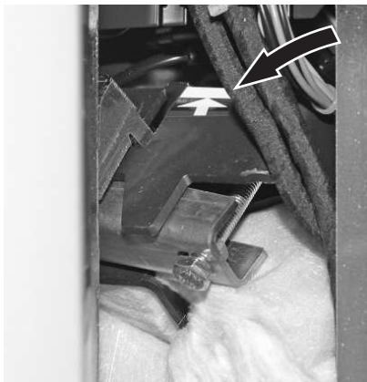
fig. 12 Avvitare saldamente le viti di fissaggio in alto fino alla battuta (marcatura)
