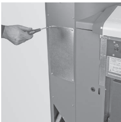
Fig. 86 Rimuovere le viti, togliere il coperchio di revisione
