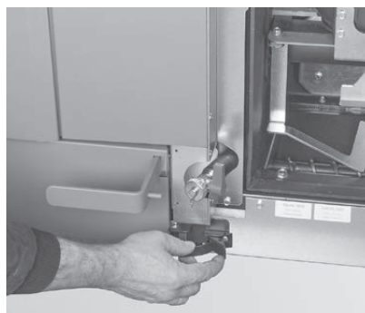
Fig. 46 Aprire la chiusura a staffa di fissaggio
