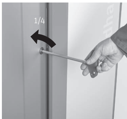
Fig. 4 Aprire la porta di contenimento con la chiave a brugola
