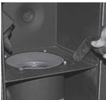
Fig. 53 Rimuovere i residui di combustione dalla camera di combustione
