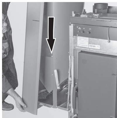
Fig. 85 Spingere la mascherina in basso e rimuoverla (chiusura a baionetta)
