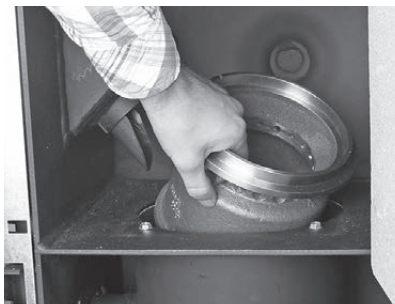
Fig. 55 Estrarre il cono parte inferiore
