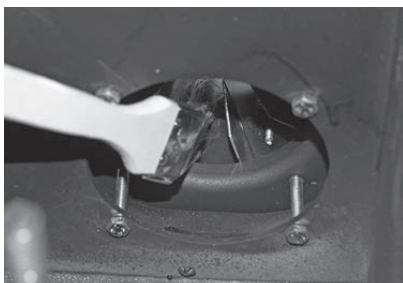
Fig. 73 Pulire e aspirare il ventilatore
