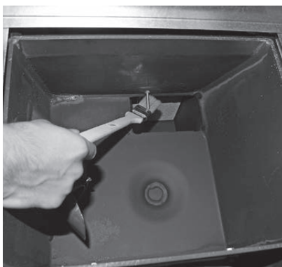
Fig. 51 Pulire la sonda Thermocontrol
