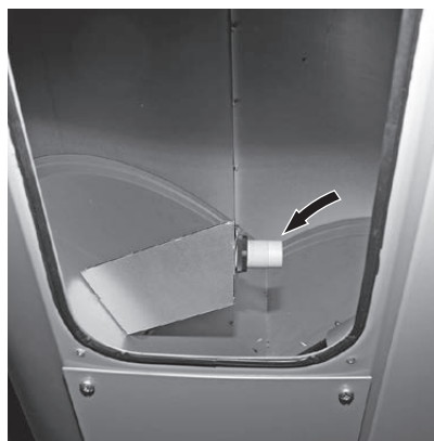
Fig. 88 Interruttore di prossimità unità di convogliamento
