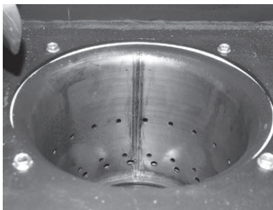
Fig. 61 Pulire i fori dell'aria secondaria nel corpo caldaia
