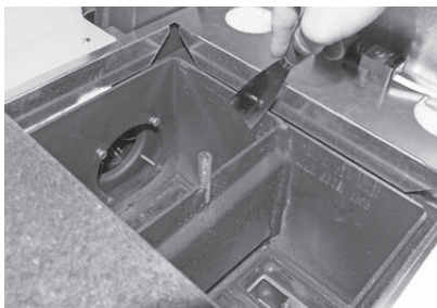
Fig. 75 Pulire le superfici riscaldanti
