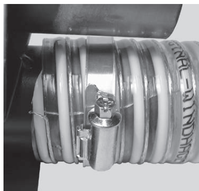
Fig. 24 Montaggio delle cravatte fermatubi
