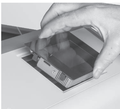
Fig.104 Inserire InfoWIN Touch nel pannello di comando
