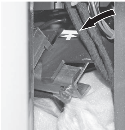
Fig. 37 Avvitare saldamente le viti di fissaggio in alto fino alla battuta (marcatura)
