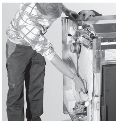
Fig. 10 Posizione della maniglia sul tubo della coclea e sul bocchettone dei gas combustivi
