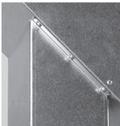
Fig. 50 Fissare il piede d'appoggio con 3 viti su ciascun lato
