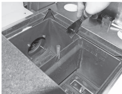
Fig. 64 Pulire le superfici riscaldanti
