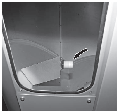
Fig. 77 Interruttore di prossimità unità di convogliamento
