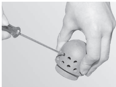
Fig. 53 Pulire con cautela la spina aria primaria
