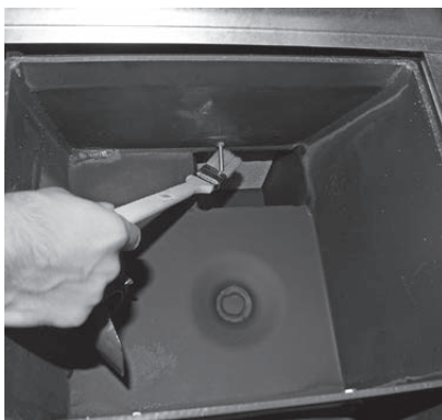
Fig. 44 Pulire la sonda Thermocontrol
