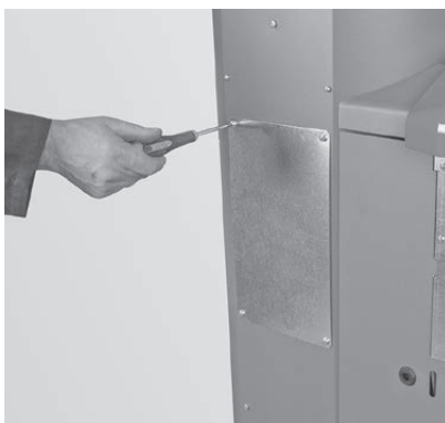
Fig. 75 Rimuovere le viti, togliere il coperchio di revisione
