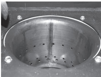
Fig. 54 Pulire i fori dell'aria secondaria nel corpo caldaia
