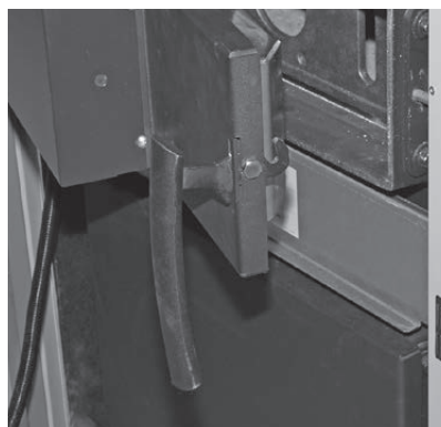
fig.10 Montare la maniglia dello sportello.
