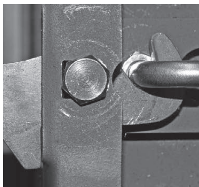
fig. 11 La linguetta di chiusura deve innestarsi completamente nella staffa di chiusura.
