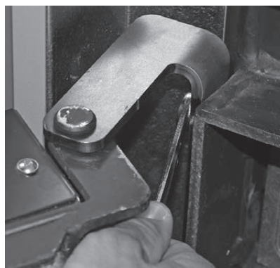
fig. 12 Regolare lo sportello di accensione spostando il supporto dello sportello.
