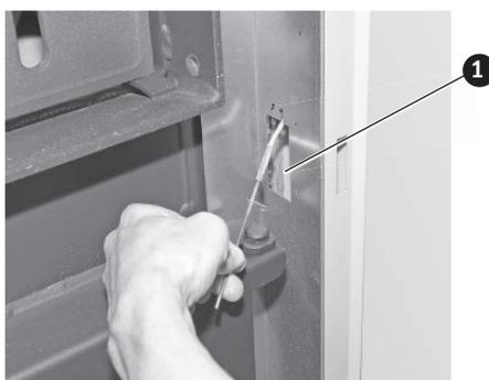
Fig. 55 Passare la sonda Thermocontrol
