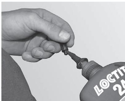
Fig. 23 Flüssige Schraubensicherung auf Ansatzschraube geben
