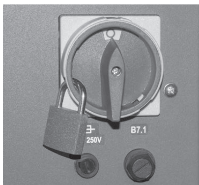
Fig. 63 Portare l'interruttore principale in posizione «0» e assicurarsi che non si riaccenda apponendo un lucchetto
