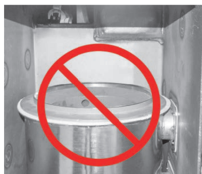
Fig. 66 NON pulire o smontare il vano combustione, pericolo di danneggiamenti!
