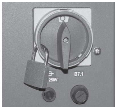
Fig.2 Portare l'interruttore principale in posizione «O» e assicurarsi che non si riaccenda apponendo un lucchetto
