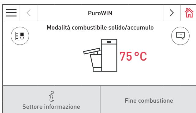
Fig. 58 Modalità combustibile solido/accumulo – Fine combustione
