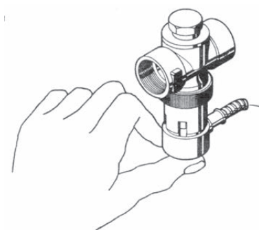
Fig.154 Valvola di sicurezza scarico termico, premere il tappo rosso contro la valvola
