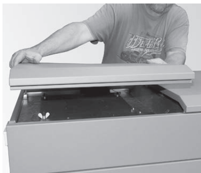
Fig. 133 Togliere la copertura posteriore
