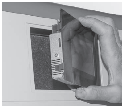
Fig. 89 Inserire InfoWIN Touch nel pannello di comando
