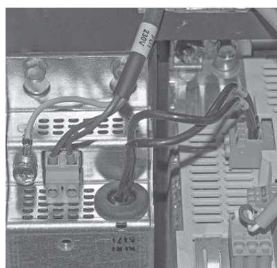
Fig. 144 Collegare filtro di rete e FU, cavo e messa a terra, inserire le spine
