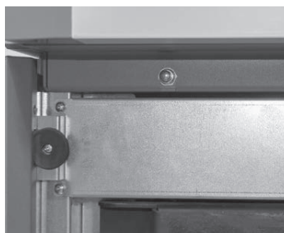
Fig. 87 Impostare l'interruttore di sicurezza porta PuroWIN PWPE 75-100
