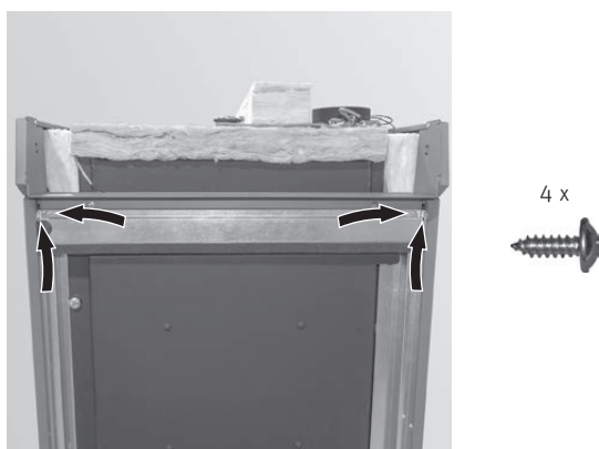
Fig. 72 Montare il rivestimento – PuroWIN PWPE 75–100
