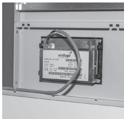
Fig. 11 Allacciare il cavo di collegamento per InfoWIN Touch
