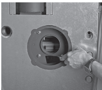
Fig. 44 Pulire l'interno della scatola del ventilatore
