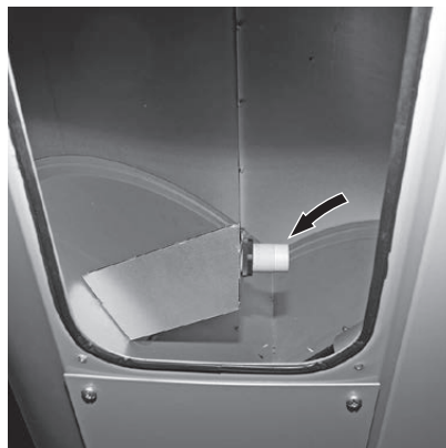
Fig. 95 Interruttore di prossimità unità di convogliamento
