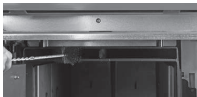
Fig. 40 Pulire l'aspirazione del gas distillato a bassa temperatura
