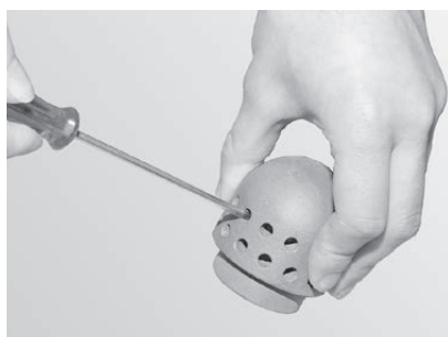
Fig. 76 Pulire con cautela la spina aria primaria
