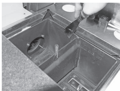
Fig. 88 Pulire le superfici riscaldanti
