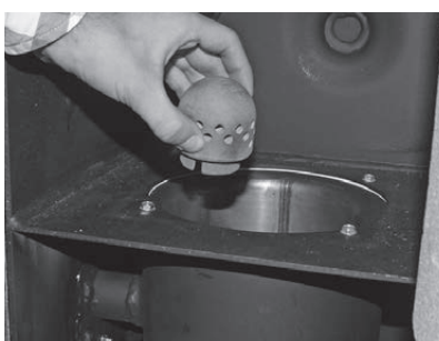
Fig. 75 Estrarre la spina aria primaria
