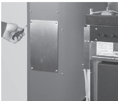
Fig. 93 Rimuovere le viti, togliere il coperchio di revisione
