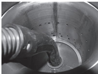
Fig. 78 Aspirare il tubo aria primaria al centro del corpo caldaia
