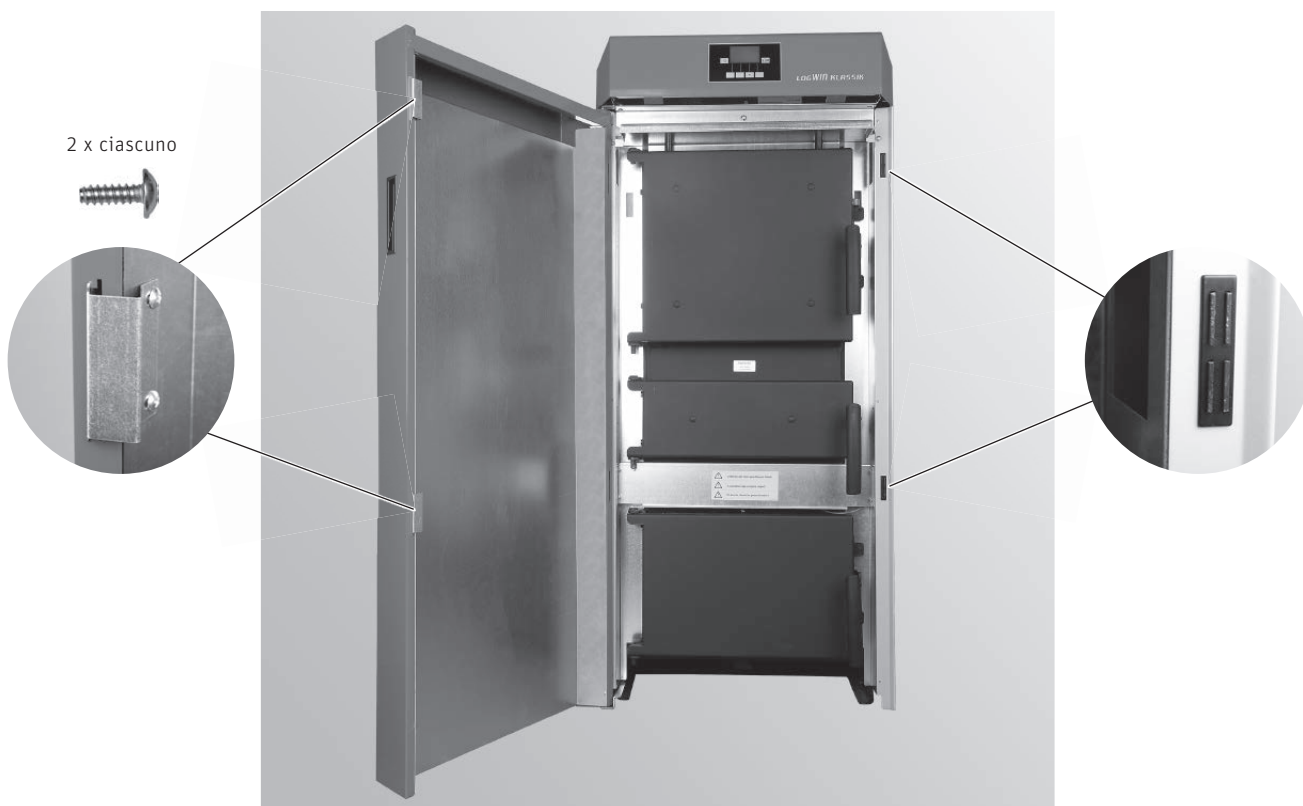
Fig. 85 Avvitare gli angolari alla porta di contenimento con 2 viti per lamiera ciascuno, inserire 2 cricchetti magnetici
