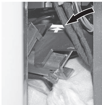
Fig. 98 Avvitare saldamente le viti di fissaggio in alto fino alla battuta (marcatura)
