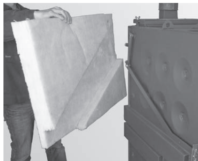
Fig. 57 Montare gli isolamenti
