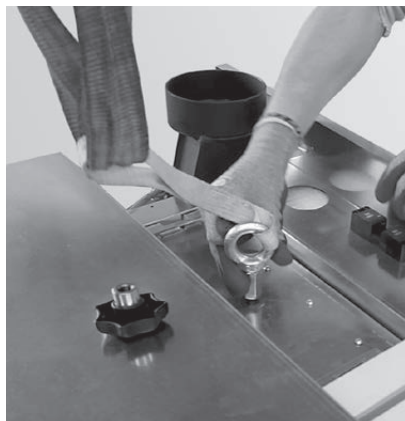
Fig. 18 Montaggio dell'occhiello (non compreso nella fornitura) per il gancio gru
