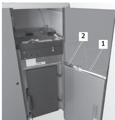
Fig.154 Pennello per la pulizia e spatola all'interno della porta di contenimento
