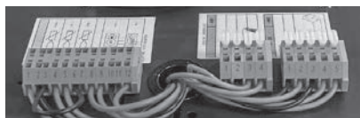
Fig. 165 Collegamento alle morsettiere (morsetti senza viti con molla a gabbia)
