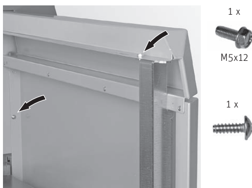
Fig. 132 Agganciare il frontale del rivestimento all'angolare e avvitare dietro e all'angolare in alto
