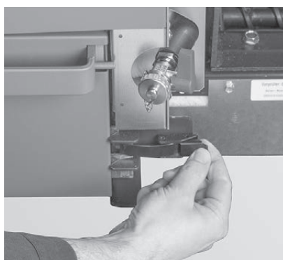
Fig. 147 Chiudere la chiusura a staffa di fissaggio
