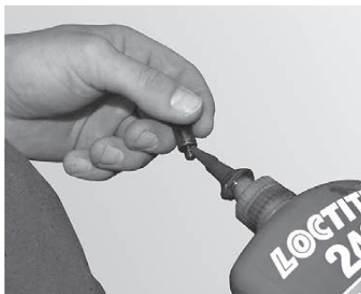
Fig. 37 Flüssige Schraubensicherung auf Ansatzschraube geben
