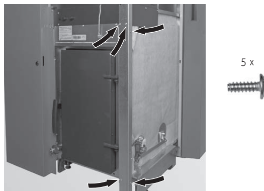
Fig. 129 Fissare l'angolare con 5 viti per lamiera
