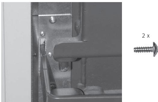
Fig. 65 Passaggio per la leva di pulizia scambiatore
