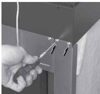
Fig. 128 Rimozione delle 2 viti
