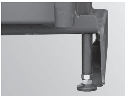
Fig. 28 Montare 2 viti di regolazione sul davanti
