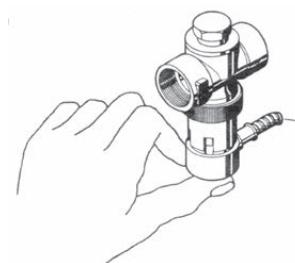
Fig. 182 Valvola di sicurezza scarico termico, premere il tappo rosso contro la valvola
