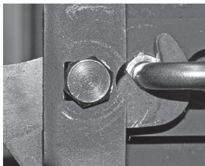
Fig. 39 La linguetta di chiusura deve innestarsi completamente nella staffa di chiusura
