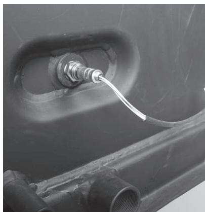
Fig. 45 Sonda Lambda montata
