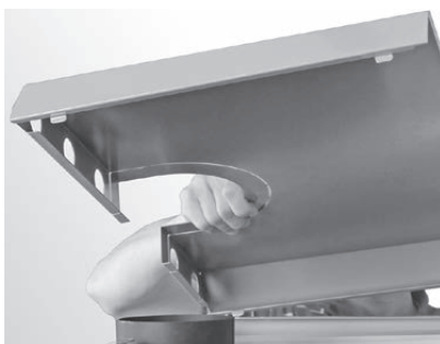
Fig. 174 Togliere la copertura posteriore della caldaia
