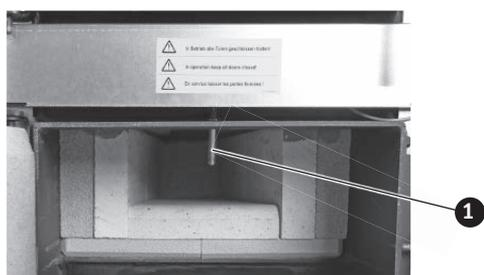
Fig. 40 Pulire la sonda Thermocontrol
