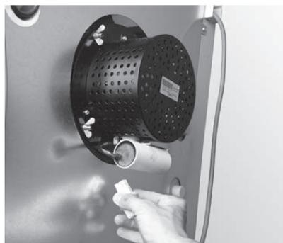
Fig. 35 Staccare la spina del ventilatore e rimuovere i dadi ad alette
