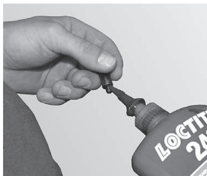
Fig. 24 Versare del liquido per bloccaggio viti sulla vite di spallamento
