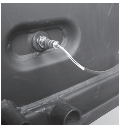
Fig. 27 Sonda Lambda montata
