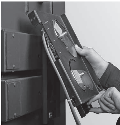
Fig. 26 Agganciare la regolazione aria in alto e avvitare sotto
