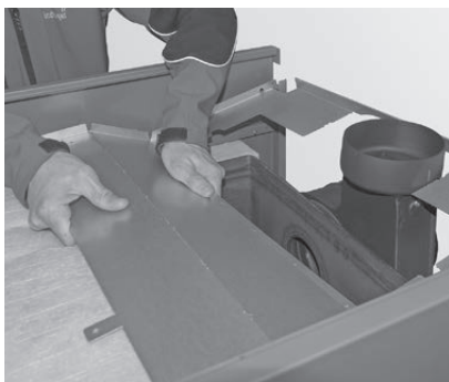
Fig. 45 Piegarla la lamiera isolante in alto
