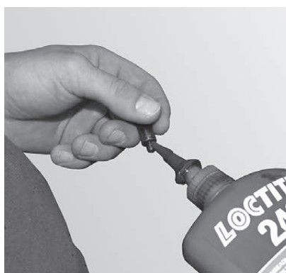
Fig. 16 Versare del liquido per bloccaggio viti sulla vite di spallamento
