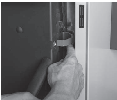
Fig. 41 Aprire il blocco dello sportello di riempimento.
