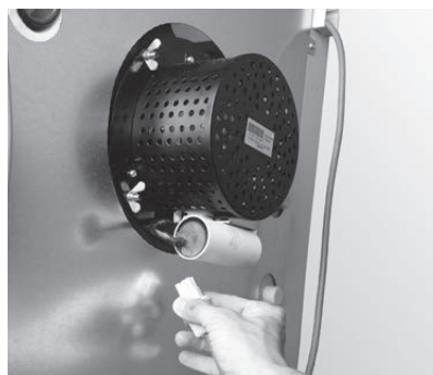
Fig. 58 Staccare la spina del ventilatore e rimuovere i dadi ad alette
