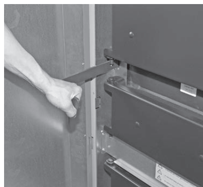
Fig. 52 Azionare la pulizia scambiatore a leva per circa 5 - 10 volte – LogWIN Klassik pellet ready
