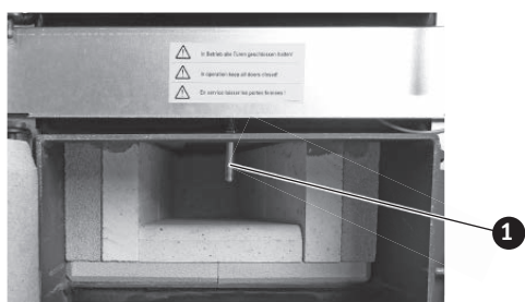
Fig. 63 Pulire la sonda Thermocontrol
