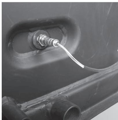
Fig. 31 Sonda Lambda montata
