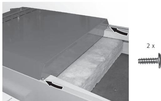
Fig. 79 Fissare la copertura della caldaia sui due lati
