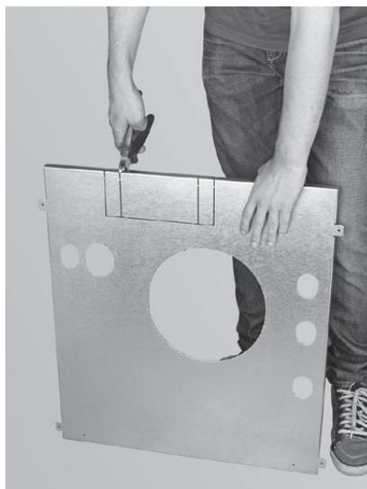
Fig. 64 Se non si utilizza alcun adattatore per raccordo gas combustibili, staccare la prepunzonatura
