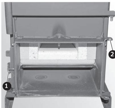
Fig. 21 Sportello cenere: invertire supporto dello sportello e supporto di chiusura
