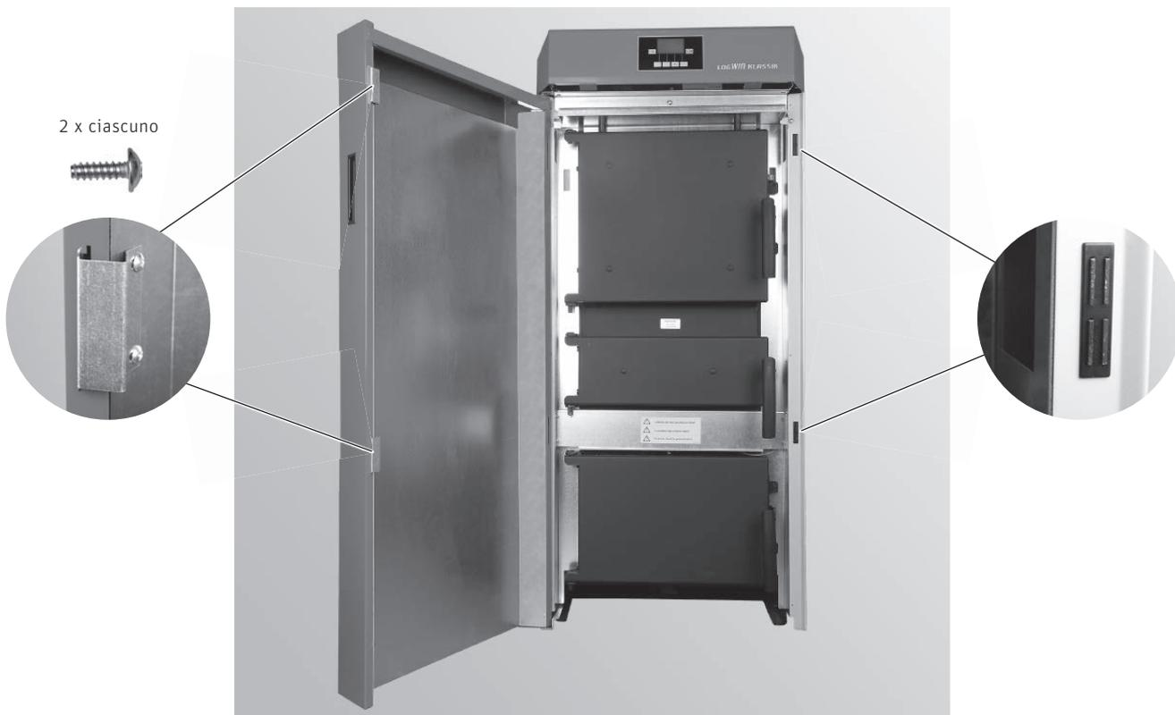
Fig. 74 Avvitare gli angolari alla porta di contenimento con 2 viti per lamiera ciascuno, inserire 2 cricchetti magnetici
