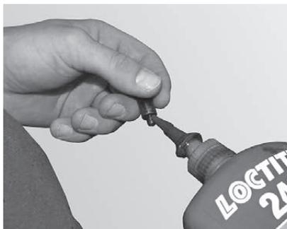
Fig. 23 Flüssige Schraubensicherung auf Ansatzschraube geben
