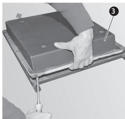
Fig. 17 Togliere l'intero pannello e riavvitarlo ruotato di 180°
