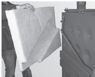
Fig. 43 Montare gli isolament (LogWIN Klassik pellet ready)
