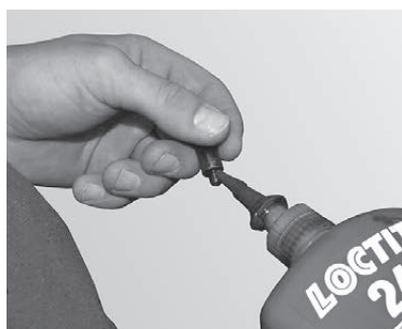
Fig. 29 Versare del liquido per bloccaggio viti sulla vite di spallamento
